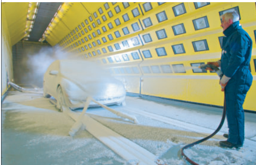
Der Klima-Wind-Kanal im Vollbetrieb: Links wird ein Pkw auf seine Betriebstauglichkeit bei Eis und Schnee geprüft, rechts ein Bus extremer Hitze ausgesetzt.
