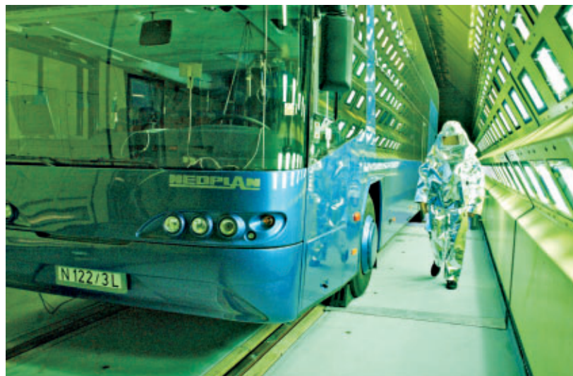
Der Klima-Wind-Kanal im Vollbetrieb: Links wird ein Pkw auf seine Betriebstauglichkeit bei Eis und Schnee geprüft, rechts ein Bus extremer Hitze ausgesetzt.
